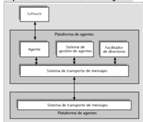
Arquitectura FIPA de un sistema multiagente
